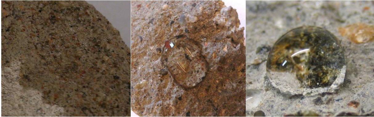
Figur 4: t.v.: Borrkärna efter torkning i 40°C direkt efter att en vattendroppe applicerats. mitten.: Spräckt betongyta där en vattenavvisande tillsats (Hycrete) blandats in. t.h.: Spräckt betongyta där en vattenavvisande impregnering använts.
