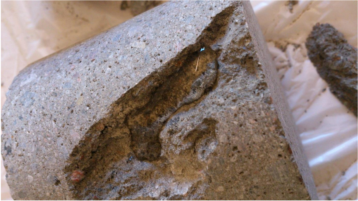
Figur 16: Hydrofoberande effekt hos borrkärna med 1 volyms-% Hycrete inblandad, v_{ct}=0,40
